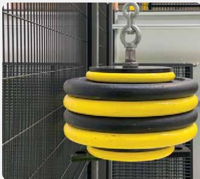
Altura de caída de la masa sobre el suelo (baricentro de la masa): **h0 = 3,145 m**
