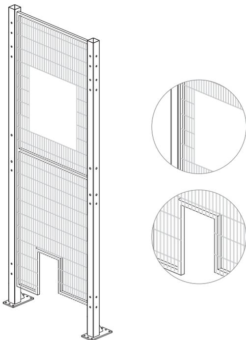
Paneles con dimensiones personalizadas o con perfilados y canteados para adaptar el vallado con partes salientes de la maquinaria como transportadores para la carga o la descarga, tableros de mando, líneas eléctricas e hidráulicas.
