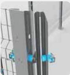
El poste universal **BlueGuard** permite efectuar tanto el montaje lineal de los paneles (180°) como el montaje angular (90°). El kit para ángulo variable es un accesorio práctico que permite unir los paneles con un ángulo comprendido entre los 20 y los 70°.
